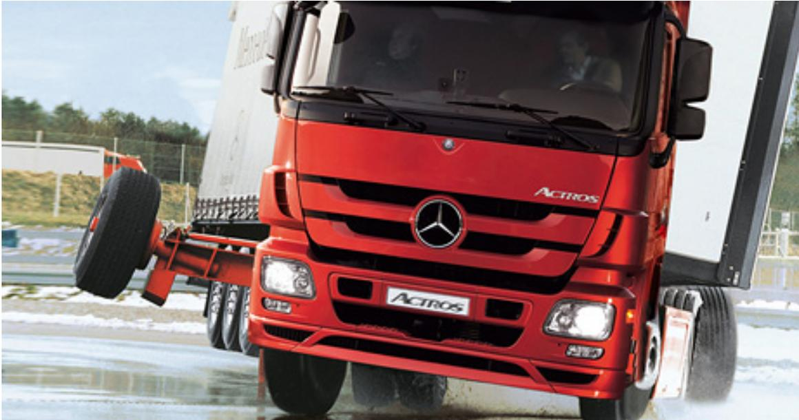
Este sistema de seguridad activa para tractocamiones contribuye a mantener la estabilidad del vehículo en situaciones críticas a través de la intervención del sistema de frenos y control del motor.
